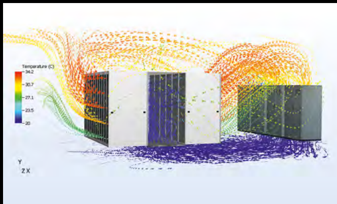
Luftstromlinien in einem nicht redundanten Gehäuse mit installierter Kaltgangeinhausung.
