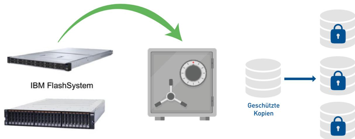
Um den schlimmen Folgen von Cyberangriffen vorzubeugen, ist es sinnvoll, Safeguarded Copy periodisch aufzusetzen, damit beispielsweise alle paar Stunden Flash-Kopien erzeugt werden. Tritt der Ernstfall ein, kann man auf die Kopie zurückgreifen, die einen konsistenten Datenbestand widerspiegelt. Dadurch
